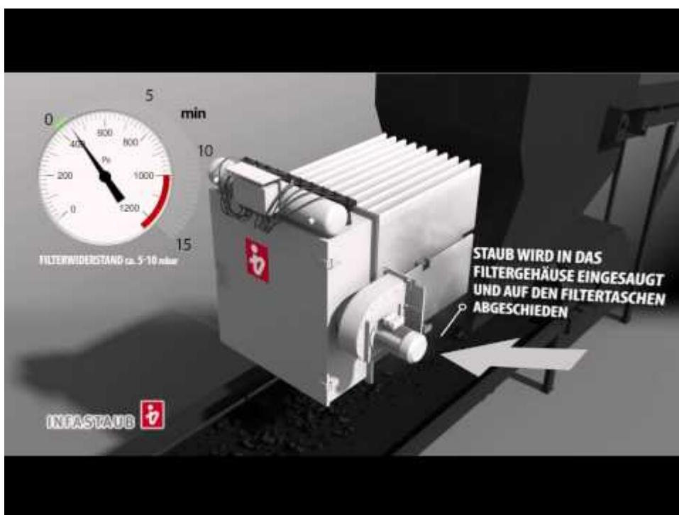
Förderbandentstaubung mit einem Aufsatzfilter in 3D Visualisierung von Infra-staub.
