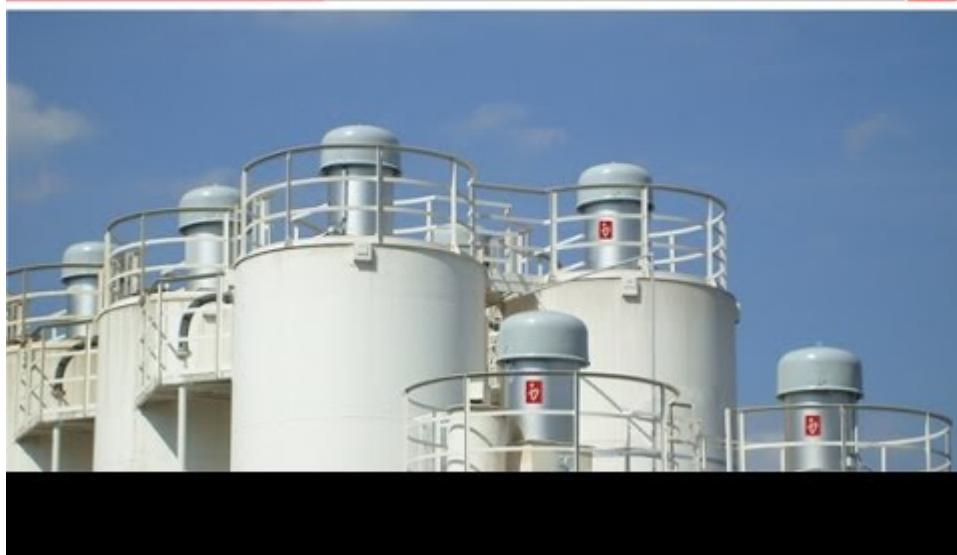
Entstaubung pneumatisch befüllter Silos oder Behälter für den störungsfreien und sicheren Silobetrieb.
