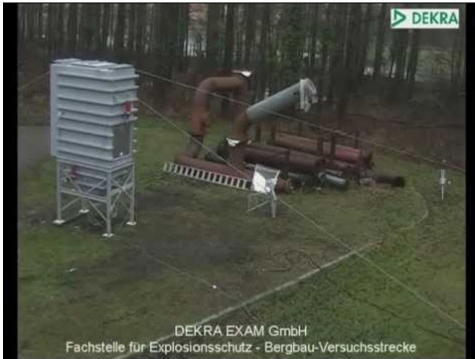
Zum Nachweis der Duckstoßfestigkeit werden im Auftrag der INFASTAUB GmbH von der DEKRA zwei Explosionstests an einem ...
